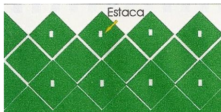
Figura 4.6-3 - Disposição das placas de grama esmeralda.
